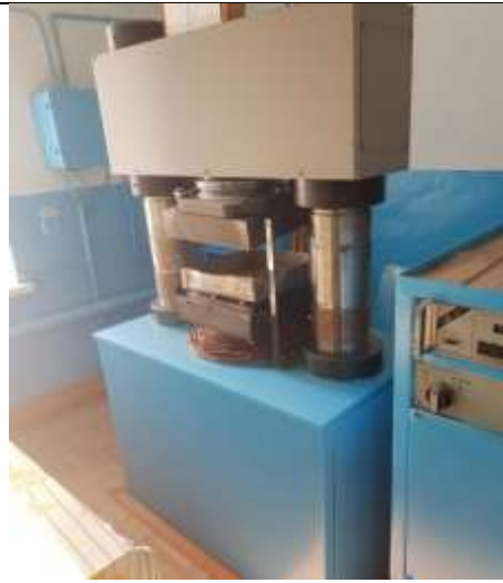
Испытательный пресс ИП-2000, система измерительная СИ-2-2000-УХЛ4.2, 1991 г/в.
